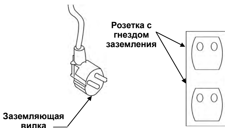
Рисунок 1. Подключение устройства к электросети
